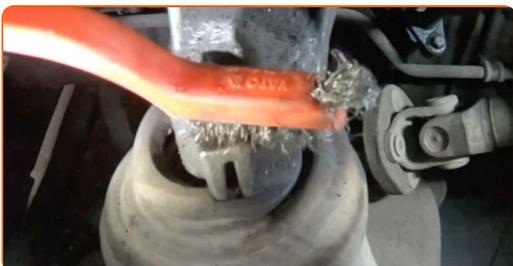
**4** Desatornille la sujeción superior del soporte del motor. Use un vaso de impacto del n.º 16. Utilice una llave de trinquete.
