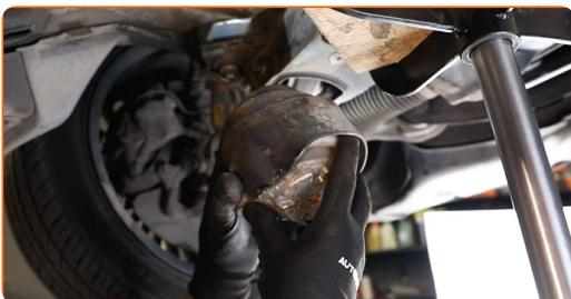
**Sustitución: soporte de motor - MERCEDES-BENZ Clase C T-modell (S203).
