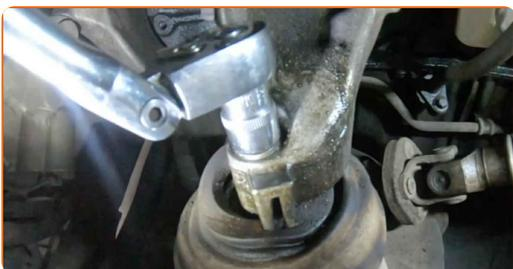
**5** Retire el perno de sujeción.
