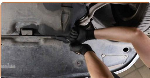
**8** Retire la cubierta del cárter de aceite.
