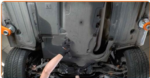
**24** Apriete los sujetadores de la cubierta inferior del cárter de aceite. Use un vaso de impacto del n.º 10. Utilice una llave de trinquete.
