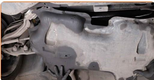
**9** Limpie las sujeciones del soporte del motor. Use un cepillo de alambre. Use el aerosol WD-40.
