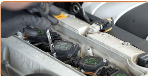
**6** Extraiga las bobinas del encendido de los pozos de la bujía.
