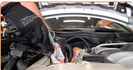
**8** Desenrosque las bujías. Use el vaso de bujía # 16. Utilice una llave de trinquete.
