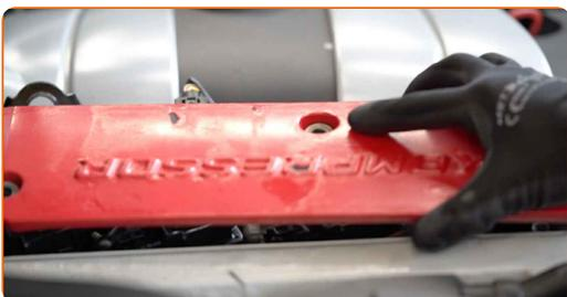
**5** Desatornille las sujeciones de las bobinas del encendido. Use un vaso de impacto del n.º E8.
