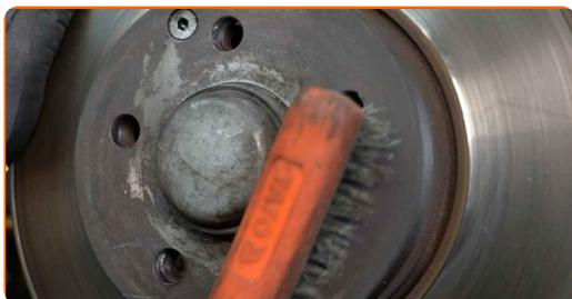
**19** Destornille la fijación del disco de freno. Use Vaso HEX No. H5. Utilice un destornillador de impacto.
