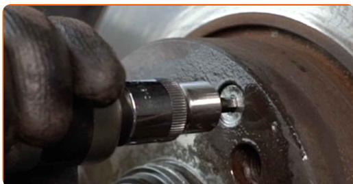
**20** Retire el perno de sujeción.
