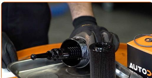
**14** Retire las juntas tóricas viejas de la tapa del filtro de aceite. Utilice un destornillador plano.
