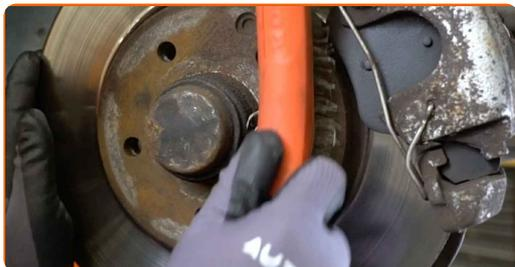
**21** Trate la superficie donde el disco del freno entra en contacto con la llanta de la rueda. Utilice grasa cerámica.
