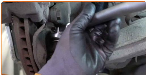
**19** Apriete la sujeción que conecta la rótula a la mangueta de dirección. Use un vaso de impacto del n.º 21. Utilice una llave dinamométrica. Apriételo a un par de 105 Nm.
