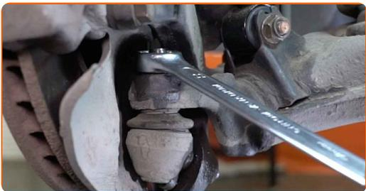
**8** Desenrosque la fijación que conecta la rótula al brazo de control de la suspensión. Use un vaso de impacto del n.º 22. Utilice una llave de trinquete.
