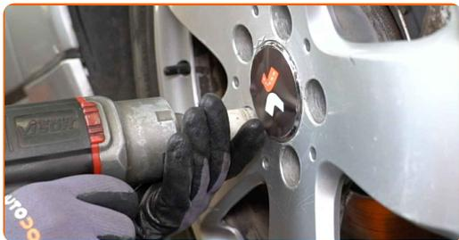
**25** Baje el automóvil y, manteniendo el orden cruzado, apriete los pernos de fijación de las ruedas. Utilice una llave de impacto para llanta # 17. Utilice una llave dinamométrica. Apriételo a un par de 110 Nm.
