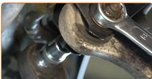
**17** Retire el perno de sujeción.
