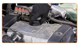
Destornille la tapa del cuerpo del filtro junto con el elemento filtrante antiguo. Utilice el vaso 62-23F. Utilice una llave de trinquete.
