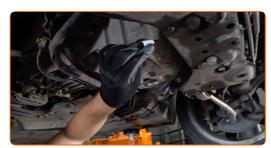
Atornille en el nuevo tapón de drenaje y apriételo. Use un vaso de impacto del n.º 24. Utilice una llave dinamométrica. Apriételo a un par de 30 Nm.
