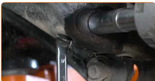
**13** Desenrosque la sujeción superior del amortiguador.
