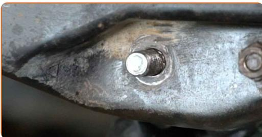
**22** Para apretar las sujeciones correctamente, debe elevar con un gato los componentes de la suspensión hasta su posición de trabajo.
