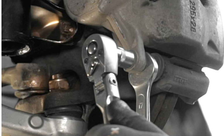
11 Retire los pernos de sujeción.
