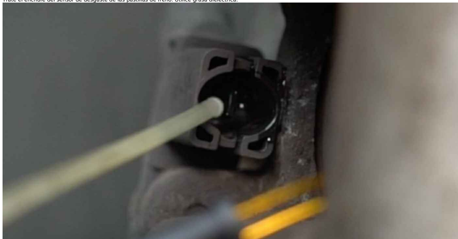
24 Una el conector del sensor de desgaste de las pastillas de freno.
