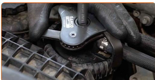
**7** Levante ligeramente la cubierta del filtro de combustible.
