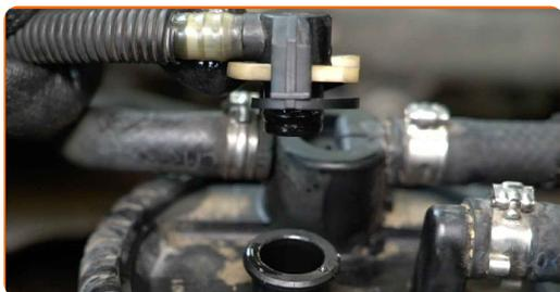
**6** Desatornille las sujeciones de la tapa de la carcasa del filtro de combustible. Utilice un extractor universal.
