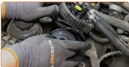
**14** Instale y apriete la tapa de la carcasa del filtro de combustible.
