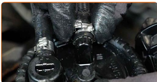
**22** Apriete la abrazadera de sujeción del tubo del filtro de combustible. Utilice alicates para abrazaderas clic-R.
