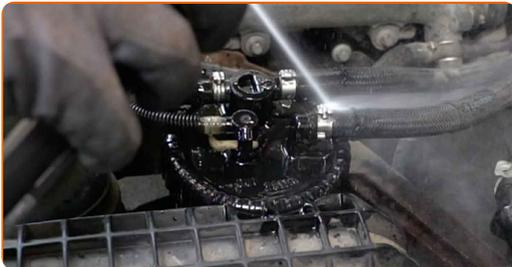
**4** Retire el clip de retención que asegura el tubo del filtro de combustible.
