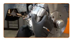
Conecte la clavija del sensor de desgaste de las pastillas de freno.
