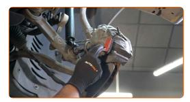
Destornille la fijación del cáliper de freno. Usa una llave mixta del n.º 17. Use un vaso de impacto del n.º 13. Utilice una llave de trinquete.
