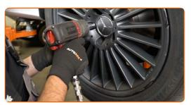
Baje el automóvil y, manteniendo el orden cruzado, apriete los pernos de fijación de las ruedas. Utilice una llave de impacto para llanta # 17. Utilice una llave dinamométrica. Apriételo a un par de 130 Nm.
