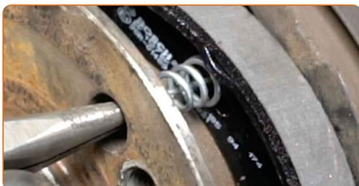
**33** Instale el muelle de retorno inferior. Utilice un destornillador plano.
