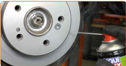
**47** Trate la superficie donde el disco del freno entra en contacto con la llanta de la rueda. Utilice grasa cerámica.
