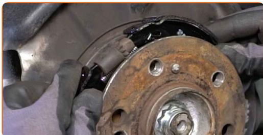
**32** Instale los muelles de sujeción de las zapatas del freno de mano. Utilice unos alicates de nariz larga.
