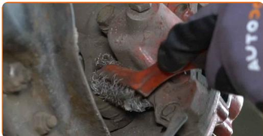
**14** Desenrosque las sujeciones de la pinza de freno. Usa una llave mixta del n.º 17.
