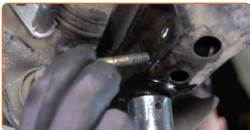
**22** Desenganche la barra estabilizadora del brazo de suspensión.
