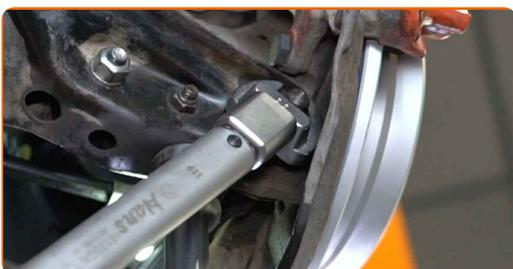
**45** Apriete la sujeción que conecta el brazo de control con el subchasis. Use una llave mixta del n.º 19. Use un vaso de impacto del n.º 19. Utilice una llave dinamométrica. Apriételo a un par de 70 Nm.
