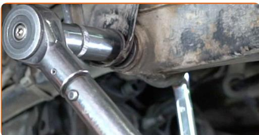
**46** Apriete las sujeciones inferiores del amortiguador. Use una llave mixta del n.º 17. Use un vaso de impacto del n.º 17. Utilice una llave dinamométrica. Apriételo a un par de 55 Nm.
