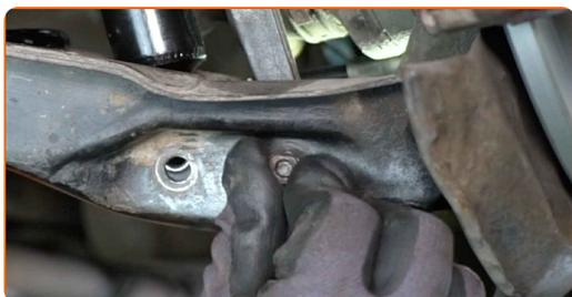
**39** Coloque el amortiguador en el paso de rueda y fíjelo.
