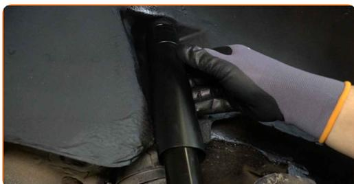
**40** Instale los elementos del soporte superior del amortiguador.
