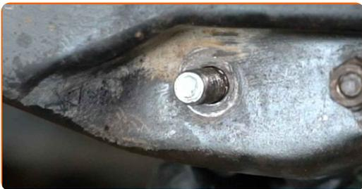
**43** Para apretar las sujeciones correctamente, debe elevar con un gato los componentes de la suspensión hasta su posición de trabajo.
