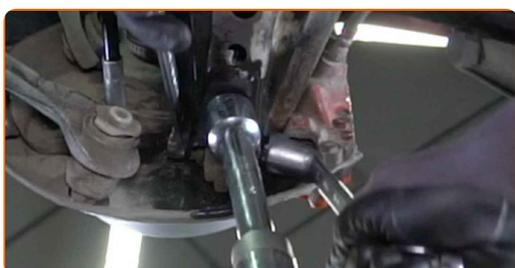
**24** Retire el apoyo de debajo del brazo de control trasero.
