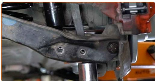
**38** Instale el perno de sujeción.
