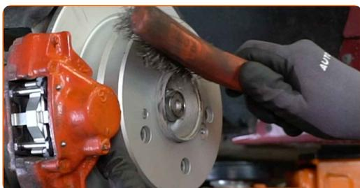
**50** Trate la superficie donde el disco del freno entra en contacto con la llanta de la rueda. Utilice grasa cerámica.
