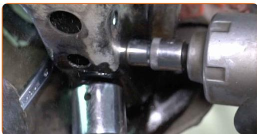
**21** Retire el perno de sujeción.
