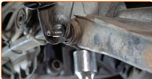
**37** Conecte la bieleta de la barra estabilizadora con el brazo de la suspensión.
