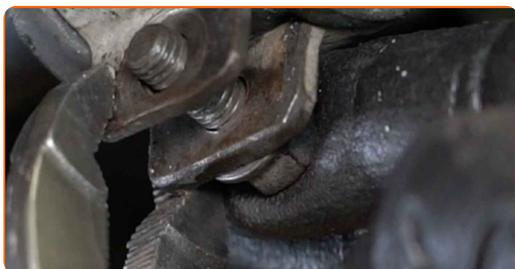
**18** Apriete las sujeciones de los casquillos de la barra estabilizadora. Usa una llave mixta del n.º 13. Use un vaso de impacto del n.º 13. Utilice una llave dinamométrica. Apriételo a un par de 20 Nm.
