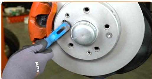
**20** Trate la superficie en la que el disco de freno entra en contacto con la llanta. Utilice grasa cerámica.
