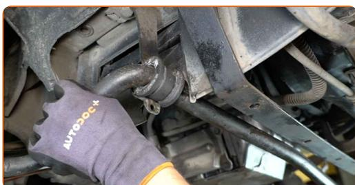
**16** Instale los soportes del cojinete del estabilizador. Use alicates de bomba de agua.
