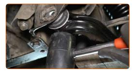
Instale los pernos de sujeción. Utilice un mazo de goma.
