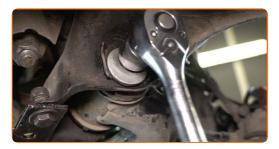
Desenrosque la sujeción delantera del brazo de control. Usa una llave mixta del n.º 22. Use un vaso de impacto del n.º 22. Utilice una llave de trinquete.
