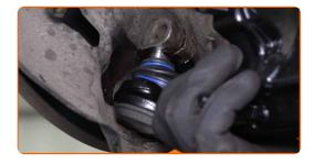
23 Instale el perno de sujeción.
