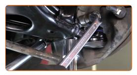
Retire el apoyo de debajo de la mangueta de dirección.
