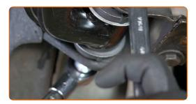
Apriete el elemento de sujeción delantero del brazo. Usa una llave mixta del n.º 22. Use un vaso de impacto del n.º 22. Utilice una llave dinamométrica. Apriételo a un par de 120 Nm.
