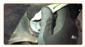
Desenrosque la sujeción trasera del brazo de control. Usa una llave mixta del n.º 22. Use un vaso de impacto del n.º 22. Utilice una llave de trinquete.
