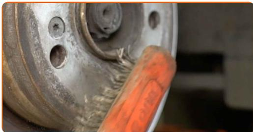
**23** Destornille la fijación del disco de freno. Utilice Torx T30. Utilice un destornillador de impacto.
