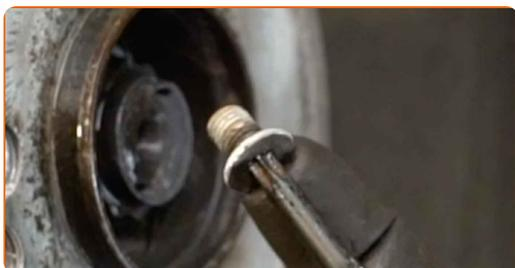
**25** Suelte el ajustador del freno de mano. Utilice un destornillador plano.
