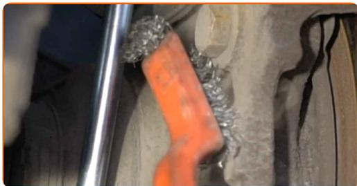
**19** Desenrosque las sujeciones del soporte de la pinza de freno. Usa una llave mixta del n.º 18.
