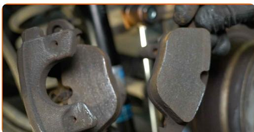
**18** Limpie las sujeciones del soporte de la pinza del freno. Use un cepillo de alambre. Use el aerosol WD-40.
