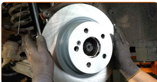
**30** Instale el perno de sujeción.
