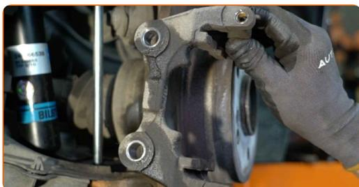
**22** Limpie la sujeción del disco de freno. Use un cepillo de alambre. Use el aerosol WD-40.
