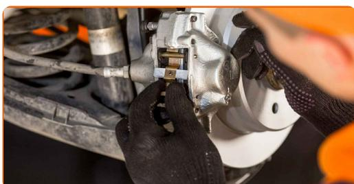
**22** Instale los clips de retención de las pastillas de freno. Use un punzón. Utilice un martillo. Use una palanca.
