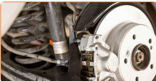
Sustitución: pinza de freno - MERCEDES-BENZ Clase E T-modell (S124).
