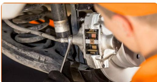
**24** Retire la abrazadera de la manguera del freno.
