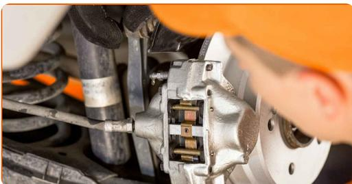
**30** Limpie la suciedad del perno del latiguillo de freno. Use un limpiador de frenos.
