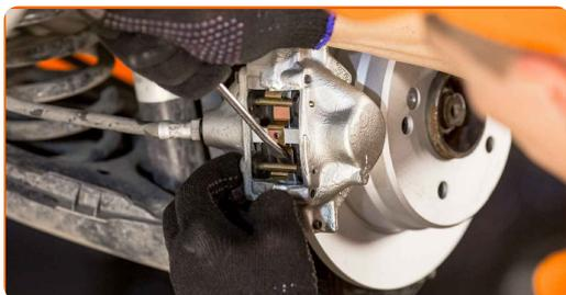
**23** Apriete la sujeción que conecta el tubo de freno a la pinza de freno. Utilice una llave de tuerca abocinada #14. Utilice una llave dinamométrica. Apriételo a un par de 18 Nm.
