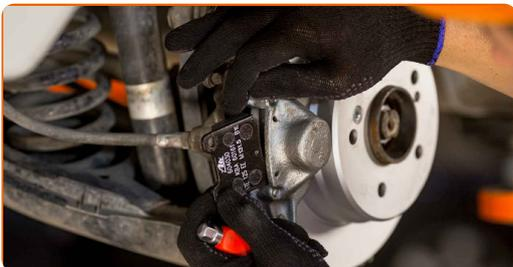
**11** Sujete el latiguillo del freno con una abrazadera de latiguillo de freno.
