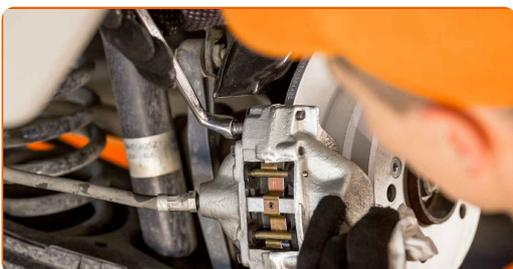
**29** Desconecte la manguera del kit de purgado de frenos.
