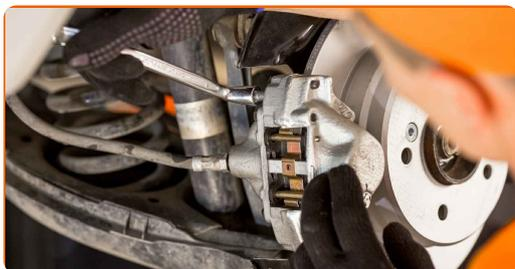
**27** Deje salir el aire del sistema del cáliper de freno.
