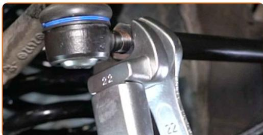
**33** Apriete la sujeción que conecta la rótula de la barra de dirección con el brazo auxiliar de dirección. Use un vaso de impacto del n.º 17. Utilice una llave dinamométrica. Apriételo a un par de 35 Nm.
