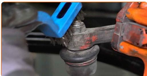
**11** Desenrosque la tuerca de sujeción que conecta la rótula de la barra de dirección a la mangueta de dirección. Use un vaso de impacto del n.º 17. Utilice una llave de trinquete.
