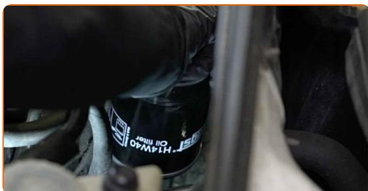
**16** Apriete el filtro de aceite. No se olvide de respetar el par de apriete recomendado. Utilice el vaso 76/14F. Utilice una llave dinamométrica. Apriételo a un par de 20 Nm.
