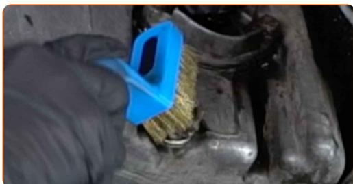
**8** Desenrosque el tapón de drenaje. Use un vaso de impacto del n.º 19. Utilice una llave de trinquete.
