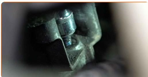
**6** Retire el perno de sujeción. Utilice un imán telescópico.
