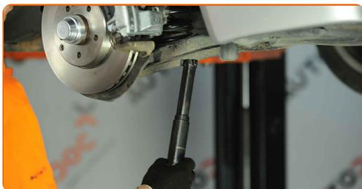
**25** Apriete la fijación inferior del amortiguador. Usa una llave mixta del n.º 17. Use un vaso de impacto del n.º 17. Utilice una llave dinamométrica. Apriételo a un par de 55 Nm.
