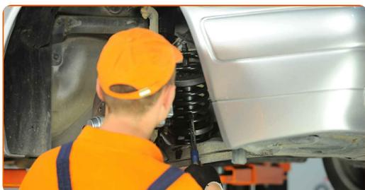
**22** Conecte la parte inferior del amortiguador. Utilice un destornillador plano.
