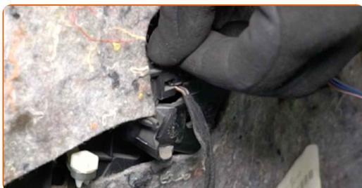
**47** Una el cable del actuador de la cerradura de la puerta.
