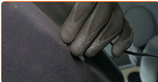
**45** Conecte el conector del módulo del interruptor del elevavinas eléctrico.
