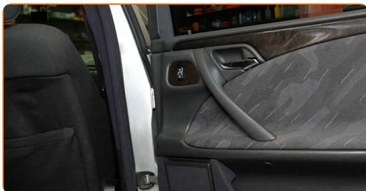
**2** Desenrosque la sujeción de la cubierta de la cerradura de la puerta. Utilice un destornillador Phillips.
