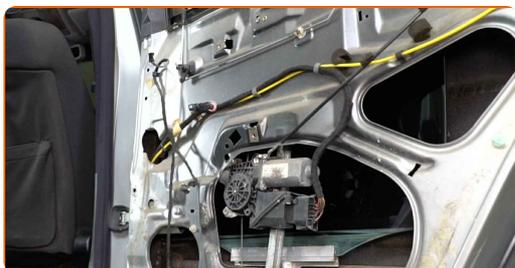
Sustitución: mecanismo de elevación - MERCEDES-BENZ Clase E T-modell (S210). Consejo:
