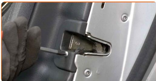
**3** Retire la cubierta de la cerradura de la puerta.
