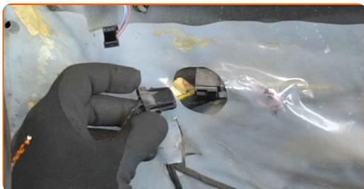
**17** Separe el aislamiento acústico del panel de la puerta.
