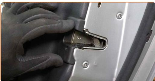
**53** Atornille la sujeción de la cubierta de la cerradura de la puerta. Utilice un destornillador Phillips.
