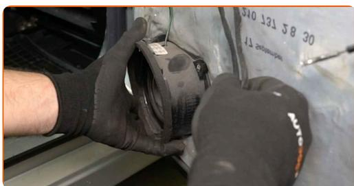
**41** Atornille las sujeciones del altavoz. Utilice un destornillador Phillips.
