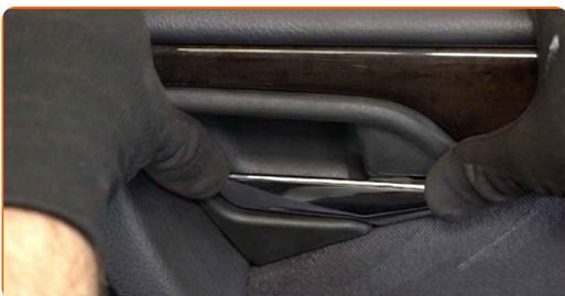
**51** Vuelva a instalar la tapa de la sujeción del panel de la puerta.
