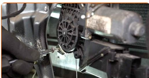
**32** Una el conector al motor del elevavinas eléctrico.
