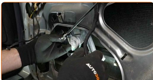
**30** Instale los remaches del mecanismo del elevavinas. Utilice una remachadora. Utilice remaches de 4,8 mm.
