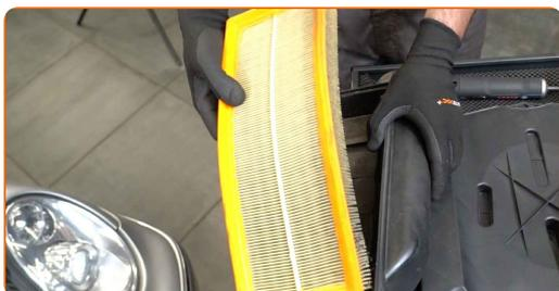
**12** Limpie la cubierta y la carcasa del filtro de aire.
