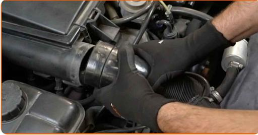
**5** Limpie la cubierta y la carcasa del filtro de aire.
