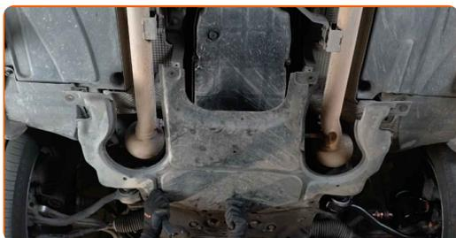
**19** Apriete los sujetadores de la cubierta inferior del cárter de aceite. Use un vaso de impacto del n.º 8. Utilice una llave de trinquete.
