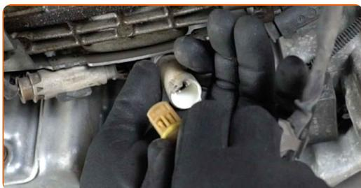
**9** Limpie la sujeción del sensor de oxígeno. Use un cepillo de alambre. Use el aerosol WD-40.
