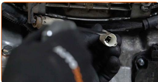
**17** Una el conector del sensor de oxígeno.
