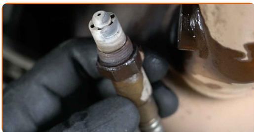
**12** Corte la rosca para el nuevo sensor de oxígeno. Utilice un macho de roscar. Utilice una llave de trinquete.
