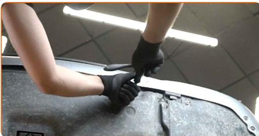
**7** Retire la cubierta del cárter de aceite.
