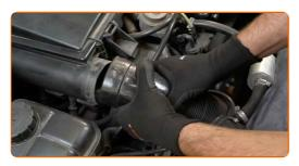
Limpie la cubierta y la carcasa del filtro de aire.
