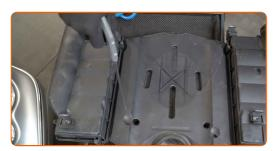
Desenrosque las sujeciones de las cubiertas del filtro de aire. Utilice Torx T20. Utilice una llave de trinquete.
