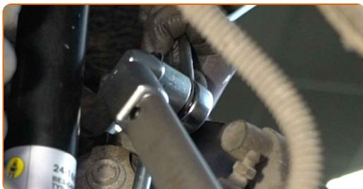
**17** Retire el apoyo de debajo de la mangueta trasera.
