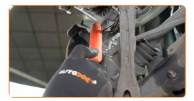
Destornille la fijación de la pinza del cáliper de freno. Use un vaso de impacto del n.º 19. Utilice una llave giramachos. Utilice una llave de trinquete.
