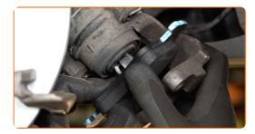
Establezcan el soporte de freno y lo fijen. Use Vaso HEX No. H7. Utilice una llave dinamométrica. Apriételo a un par de 28 Nm.
