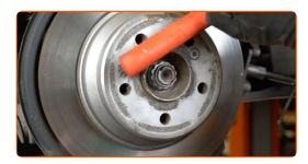
Destornille la fijación del disco de freno. Utilice Torx T30. Utilice un destornillador de impacto.
