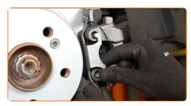
Conecte el captador de desgaste de las pastillas de freno.
