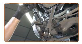
Empuje hundiendo el cáliper de freno. Utilice la herramienta de retorno del pistón de freno.
