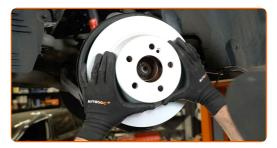
Apriete la fijación del disco de freno. Utilice Torx T30. Utilice una llave dinamométrica. Apriételo a un par de 8 Nm.
