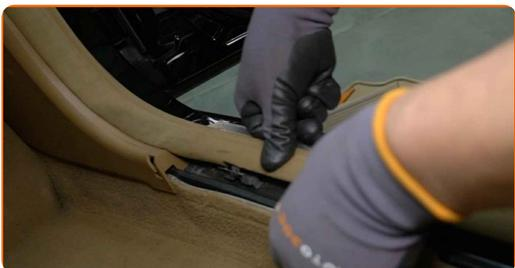
**15** Instale la cubierta interior del umbral de la puerta.
