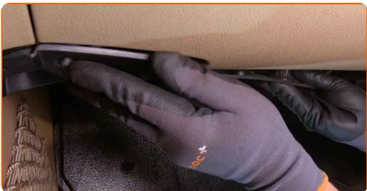
**12** Atornille las sujeciones del panel lateral inferior del pasajero. Utilice Torx T20.
