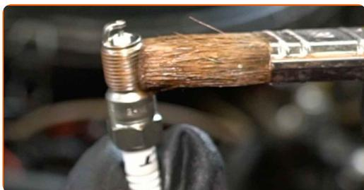
**12** Instale las nuevas bujías en sus asientos de montaje.
