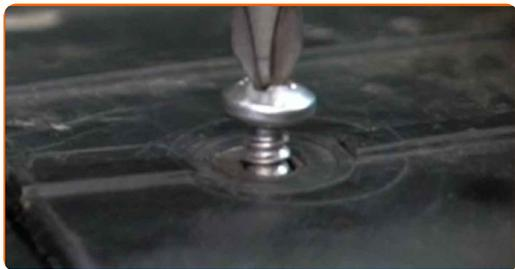
**17** Atornille las sujeciones del tubo de admisión. Utilice un destornillador Phillips. Use un vaso de impacto del n.º 10. Utilice una llave de trinquete.
