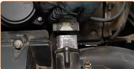
**4** Afloje la abrazadera de sujeción que conecta el conducto de aire a la carcasa del filtro de aire. Use un vaso de impacto del n.º 7. Utilice una llave de trinquete.
