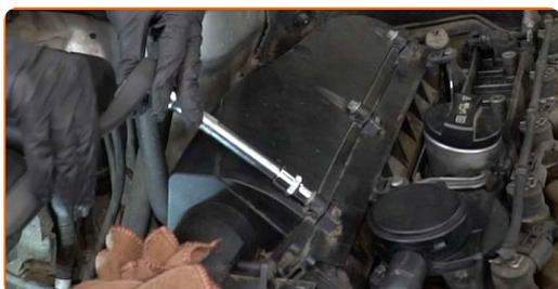
**7** Retire la cubierta del filtro de aire.
