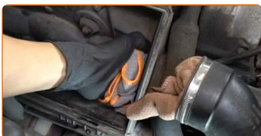
**10** Limpie la cubierta y la carcasa del filtro de aire.
