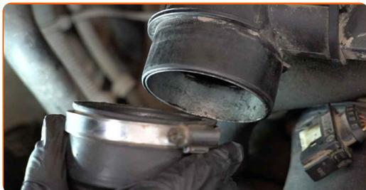
**6** Afloje los tornillos de sujeción de la cubierta del filtro de aire. Use un vaso de impacto del n.º E11. Utilice una llave de trinquete.
