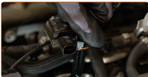
**12** Desenganche el retén del filtro de combustible. Use una palanca.
