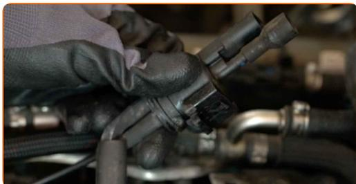
**7** Separe el conector del sensor de nivel de agua en el combustible.
