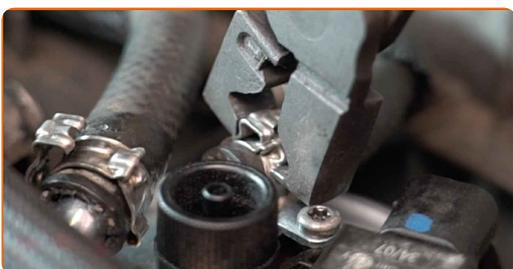
**20** Fije el conector del sensor de nivel de agua en el combustible.
