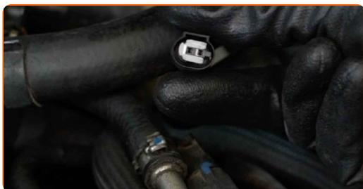
**6** Separe la válvula de vacío de su asiento de montaje y déjela a un lado. Use una palanca.
