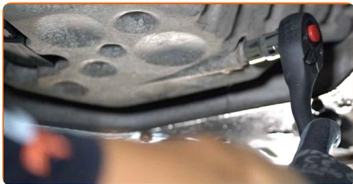
**14** Destornille el tapón de desagüe. Use un vaso de impacto del n.º 13. Utilice una llave de trinquete.
