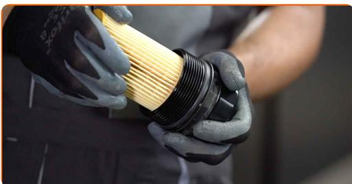
**19** Instale el nuevo filtro de aceite en el asiento de montaje de la cubierta del filtro.
