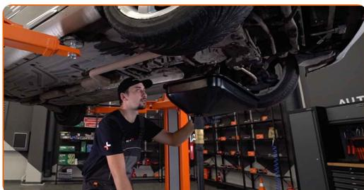
**13** Coloque un contenedor para el aceite de desecho con al menos 8 l de capacidad debajo del orificio de drenaje.
