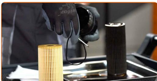
**17** Retire la junta tórica de la tapa del filtro de aceite. Utilice un destornillador plano.
