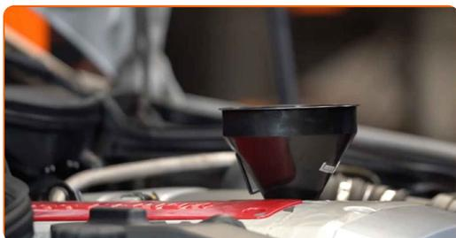
**28** Atornille la tapa. Utilice el vaso 76-14F. Utilice una llave dinamométrica. Apriételo a un par de 25 Nm.
