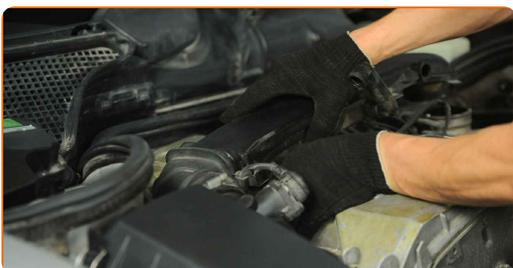
**8** Retire la tubuladura del filtro de aire.
