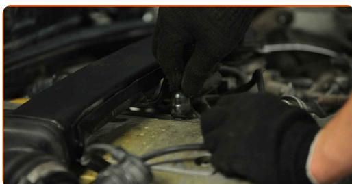
**30** Fije la abrazadera en el manguito de admisión de aire. Utilice un destornillador plano.
