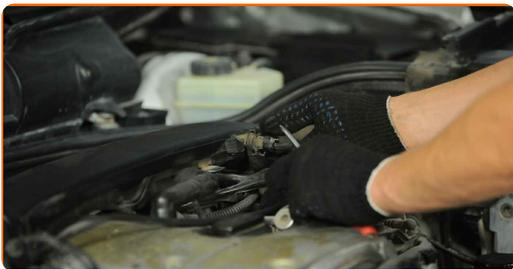
**5** Suelte la abrazadera del manguito de admisión de aire. Utilice un destornillador plano.
