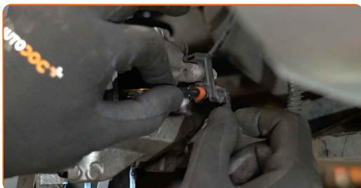
**28** Trate la superficie donde el disco del freno entra en contacto con la llanta de la rueda. Use grasa de cobre.
