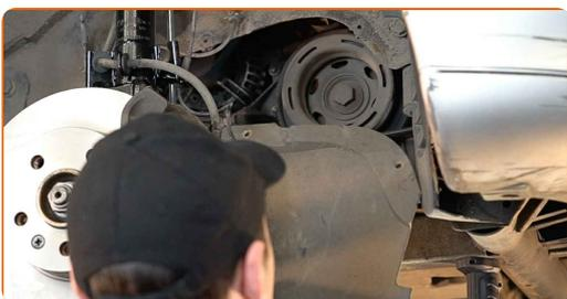
**10** Destornille la fijación delantera de la palanca. Usa una llave mixta del n.º 18. Use un vaso de impacto del n.º 19. Utilice una llave de trinquete.
