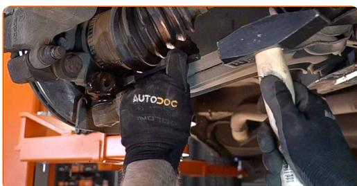
**15** Desconecte la bisagra esférica del brazo. Use una palanca.
