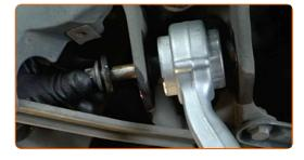
Conecte el apoyo esférico al muñón de dirección.
