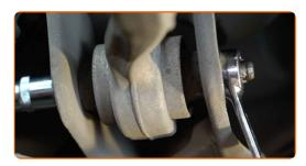
Destornille la fijación del soporte esférico del muñón de dirección. Usa una llave mixta del n.º 21.
