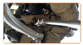
Apriete la sujeción que conecta el brazo de control con el subchasis. Usa una llave mixta del n.º 21. Utilice Torx E20. Utilice una llave dinamométrica. Apriételo a un par de 80 Nm.+120°
