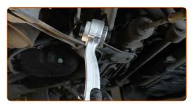
Sustitución: brazo inferior de la parte delantera - MERCEDES-BENZ CLC (CL203). Consejo de AUTODOC:
