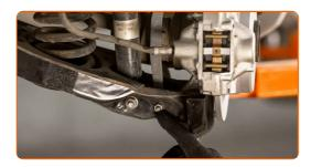
Desatornille la sujeción que conecta la bieleta de barra estabilizadora con el brazo de control. Usa una llave mixta del n.º 13. Use un vaso de impacto del n.º 13. Utilice una llave de trinquete.
