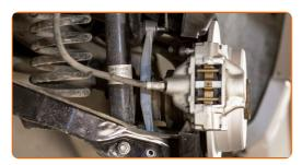
Apriete la sujeción que conecta la bieleta a la barra estabilizadora. Usa una llave mixta del n.º 17. Usa una llave mixta del n.º 19. Utilice una llave dinamométrica. Apriételo a un par de 30 Nm.
