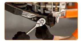
Desatornille la sujeción que conecta la bieleta a la barra estabilizadora. Usa una llave mixta del n.º 17. Usa una llave mixta del n.º 19.
