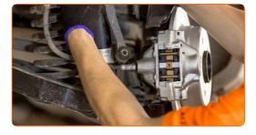
Limpie los asientos de montaje de la bieleta de barra estabilizadora. Use un cepillo de alambre. Use el aerosol WD-40.
