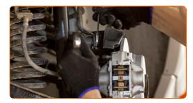
Instale la sujeción que conecta la bieleta de suspensión al brazo de control y apriétela. Usa una llave mixta del n.º 13. Use un vaso de impacto del n.º 17. Utilice una llave dinamométrica.
