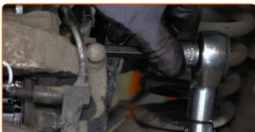
**22** Instale las tapas de los fuelles guía de la pinza de freno.
