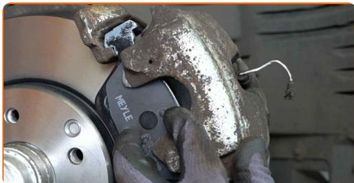
**21** Apriete las sujeciones de la pinza del freno. Use Vaso HEX No. H7. Utilice una llave dinamométrica. Apriételo a un par de 25 Nm.
