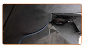
Atornille las sujeciones del panel de guarnecido. Utilice un destornillador Phillips.
