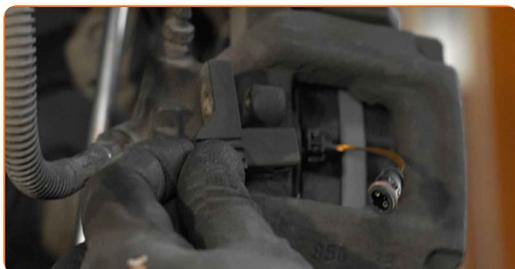
**28** Instale el perno de sujeción.
