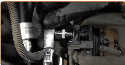
**10** Retire el perno de sujeción.
