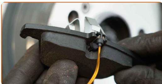
**22** Trate las pastillas de freno en el área donde su superficie entra en contacto con el soporte de la pinza de freno. Use pasta antichirridos.
