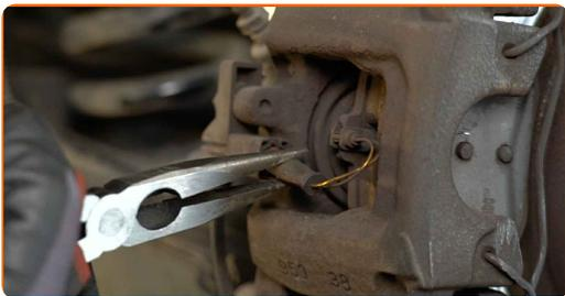
**8** Limpie las sujeciones del juego de cables del sensor de desgaste de las pastillas de freno. Use un cepillo de alambre. Use el aerosol WD-40.
