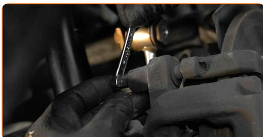
**15** Separe las pastillas de freno. Use una palanca.
