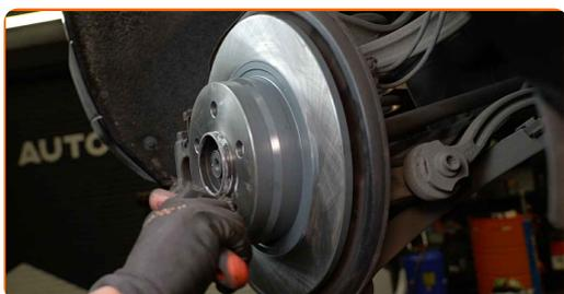
**34** Trate la superficie donde el disco del freno entra en contacto con la llanta de la rueda. Utilice grasa cerámica.
