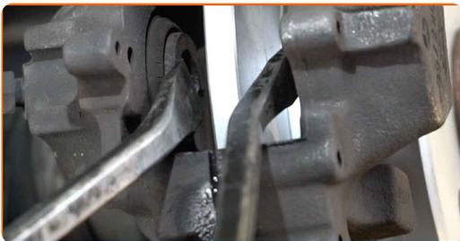
**14** Trate las pastillas de freno en el área donde su superficie entra en contacto con el soporte de la pinza de freno. Use pasta antichirridos.
