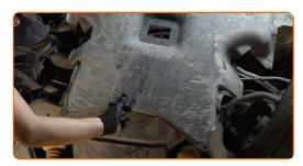
8 Separe el conector del sensor de oxígeno.
