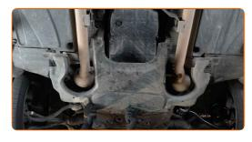
Apriete los sujetadores de la cubierta inferior del cárter de aceite. Use un vaso de impacto del n.º 8. Utilice una llave de trinquete.
