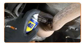
Desenrosque la sujeción del sensor de oxígeno. Utilice un vaso para sensor de oxígeno de 22 mm. Utilice una llave de trinquete.
