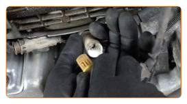
Limpie la sujeción del sensor de oxígeno. Use un cepillo de alambre. Use el aerosol WD-40.
