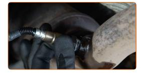
Apriete la sujeción del sensor de oxígeno. Usa una llave mixta del n.º 22. Utilice una llave dinamométrica. Apriételo a un par de 51 Nm.
