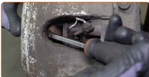
**11** Retire las tapas de los fuelles guía de la pinza de freno. Use una palanca.
