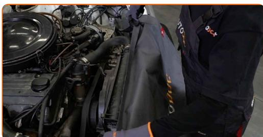
**3** Desenrosque la sujeción que conecta el muelle neumático del capó con la carrocería. Usa una llave mixta del n.º 13 (2 piezas).
