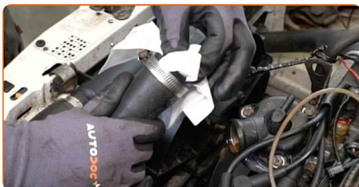
**12** Desenrosque las sujeciones de la carcasa del termostato. Use un vaso de impacto del n.º 10. Utilice una llave de trinquete.
