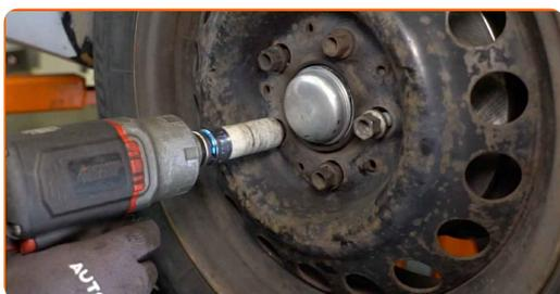
**50** Baje el automóvil y, manteniendo el orden cruzado, apriete los pernos de fijación de las ruedas. Utilice una llave de impacto para llanta # 17. Utilice una llave dinamométrica. Apriételo a un par de 110 Nm.
