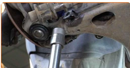
**37** Ajuste la posición de los pernos de ajuste de la inclinación según las marcas.
