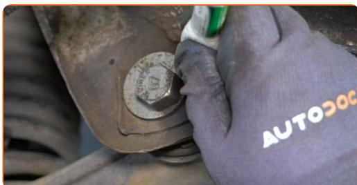
**16** Desenrosque la sujeción delantera del brazo de control. Usa una llave mixta del n.º 22. Use un vaso de impacto del n.º 22. Utilice una llave de trinquete.
