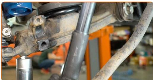
**36** Para apretar las sujeciones correctamente, debe elevar con un gato los componentes de la suspensión hasta su posición de trabajo.
