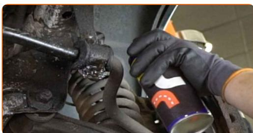
**10** Desatornille las sujeciones de los soportes del cojinete del estabilizador. Usa una llave mixta del n.º 13. Use un vaso de impacto del n.º 13. Utilice una llave de trinquete.
