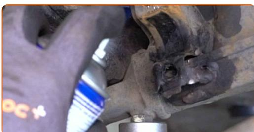
**15** Limpie las sujeciones del brazo de control. Use un cepillo de alambre. Use el aerosol WD-40.
