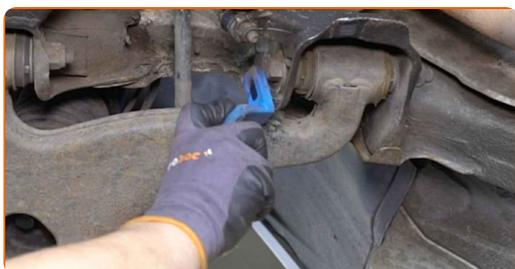
**16** Haga marcas en los pernos de ajuste de la inclinación.
