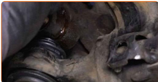
**33** Apriete la sujeción que conecta la rótula a la mangueta de dirección. Usa una llave mixta del n.º 19. Use un vaso de impacto del n.º 19. Utilice una llave dinamométrica. Apriételo a un par de 75 Nm.
