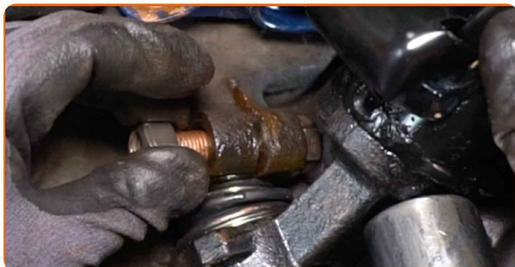
**31** Instale el muelle junto con el compresor.
