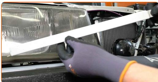
**6** Desenrosque las sujeciones superiores del faro delantero. Utilice un destornillador Phillips.
