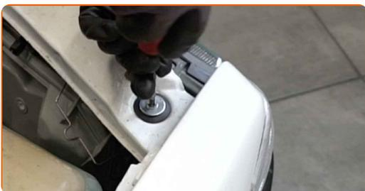
**34** Atornille la sujeción inferior del faro delantero. Use un vaso de impacto del n.º 10. Utilice una llave de trinquete.
