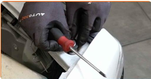
**33** Atornille las sujeciones superiores del faro delantero. Utilice un destornillador Phillips.
