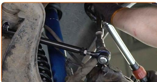
**33** Instale el amortiguador de dirección.
