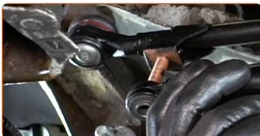
**35** Apriete las sujeciones del amortiguador de dirección. Use un vaso de impacto del n.º 17. Utilice una llave dinamométrica. Apriételo a un par de 40 Nm.
