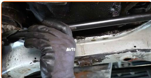
**26** Apriete las sujeciones que conectan las rótulas de la barra de acoplamiento central a los brazos auxiliares de dirección. Use un vaso de impacto del n.º 17. Utilice una llave dinamométrica. Apriételo a un par de 35 Nm.
