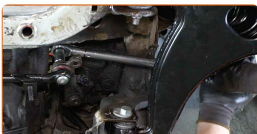
**27** Ajuste la longitud de las nuevas barras de dirección, tomando como referencia las antiguas. Usa una llave mixta del n.º 13. Usa una llave mixta del n.º 19. Usa una llave mixta del n.º 22. Use un vaso de impacto del n.º 13. Utilice una llave de trinquete. Utilice un calibrador Vernier.
